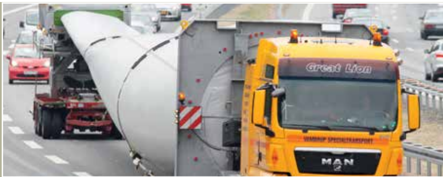
75 Meter Länge: Das längste Rotorblatt wird mit einer Höchstgeschwindigkeit von bis zu 67 Kilometer pro Stunde transportiert.
