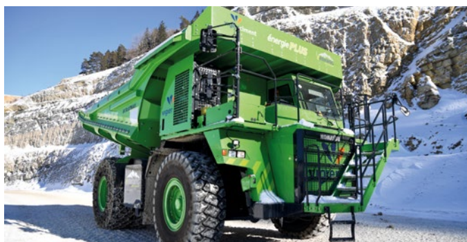
Der E-Dumper kann als Plusenergie-Fahrzeug eingesetzt werden. Beim Betrieb wird gleichzeitig CO 2 -freier Strom erzeugt.
